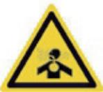
Non utilizzare mai l'invertitore in un ambiente chiuso, poiché i gas di scarico del motore contengono monossido di carbonio. Azionare l'inverter solo all'aperto, lontano da finestre, porte e prese d'aria.
