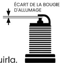
Se la candela non soddisfa nessuna delle condizioni sopra elencate, sostituirla.
