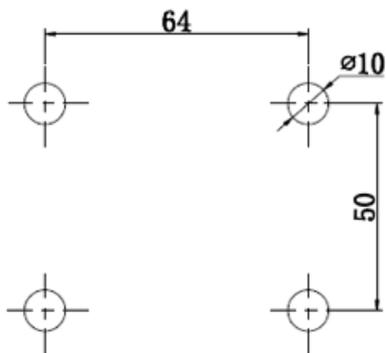
2. Coloque as âncoras nos orifícios: usando um martelo, insira as âncoras de 10 mm nos orifícios.
