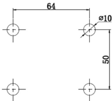
2. Colocar los anclajes en los agujeros: con ayuda de un martillo, inserte los anclajes de 10mm en los orificios.
