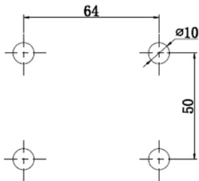
2. Placez les ancrages dans les trous: à l'aide d'un marteau, insérez les ancrages de 10mm dans les trous.
