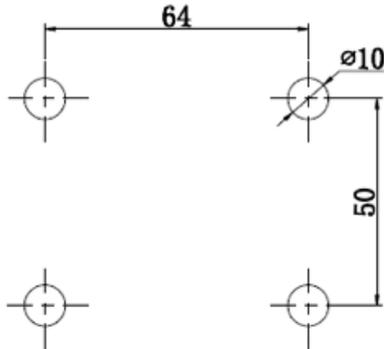
2. Setzen Sie die Anker in die Löcher ein: Setzen Sie die 10-mm-Anker mit Hilfe eines Hammers in die Löcher ein
