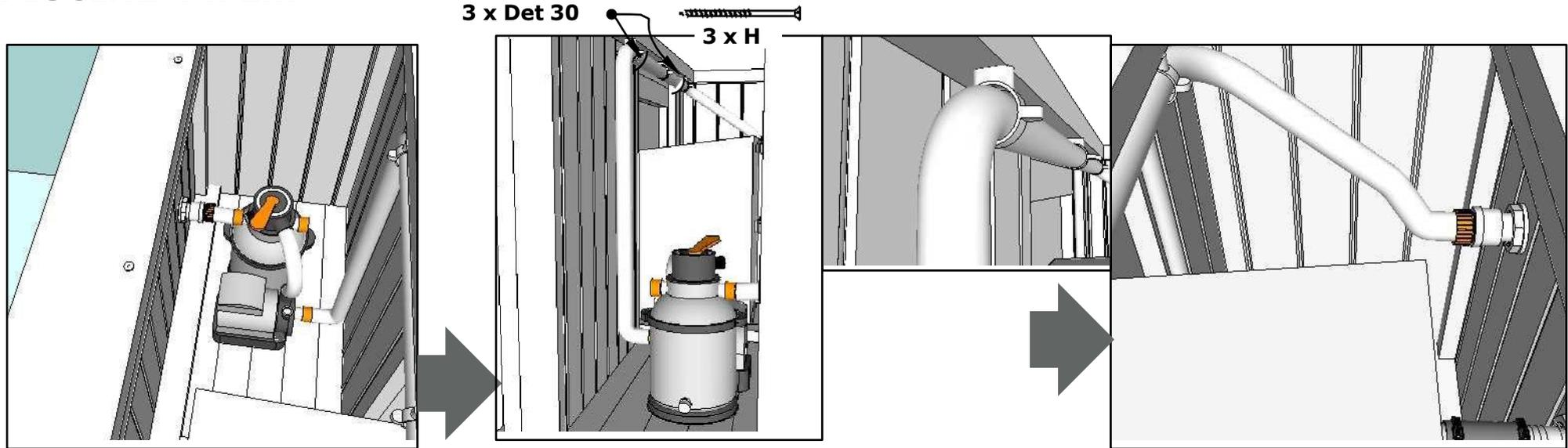
**I** Installez le système de filtration(29) et connecter les tuyaux. Lisez le manuel du système de filtration
