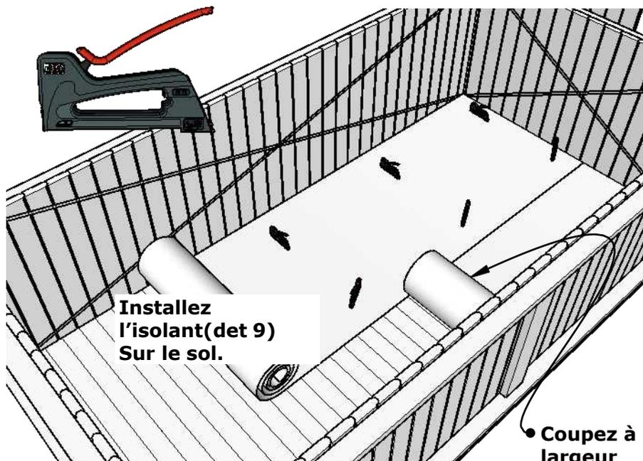
Installez l'isolant (det 9) Sur le sol.
