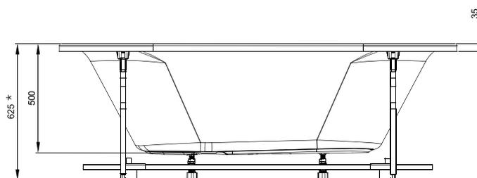
\* Cette cote correspond à la hauteur de la baignoire équipée d'un tablier. Réglage des pieds +/- 5 mm.
