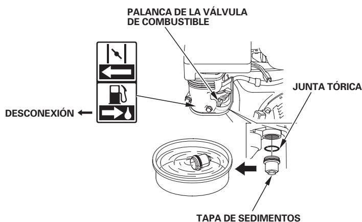
3. Ponga la junta tórica en la válvula de combustible, e instale la taza de sedimentos. Apriete con seguridad la taza de sedimentos.
