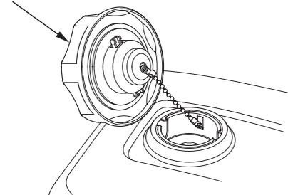
2. Añada combustible hasta la parte inferior del límite del nivel de combustible del depósito de combustible. No llene excesivamente. Frote el combustible que se haya derramado antes de arrancar el motor.
