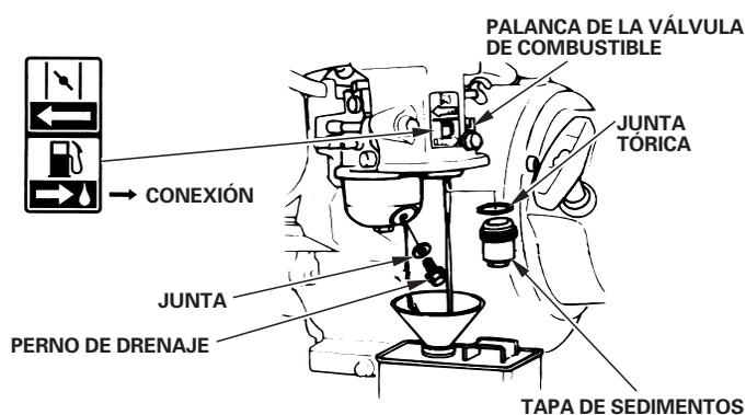
4. Después de haber drenado todo el combustible en el recipiente, vuelva a instalar el perno de drenaje, la empaquetadura, la taza de sedimentos y la junta tórica. Apriete con seguridad el perno de drenaje y la taza de sedimentos.
