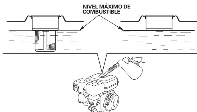
3. Reposte con cuidado para que no se derrame combustible. No llene por completo el depósito de combustible. Es posible que sea necesario reducir el nivel del combustible dependiendo de las condiciones de operación. Después de repostar, apriete con seguridad la tapa de relleno de combustible.
