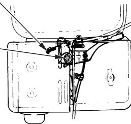
Montaje del núcleo del cable flexible
