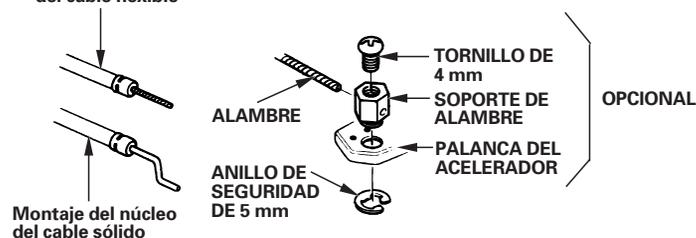
Montaje del núcleo del cable sólido
