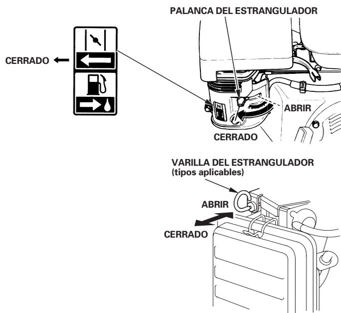
Para arrancar el motor cuando está caliente, deje la palanca del estrangulador o la varilla del estrangulador en la posición OPEN.
