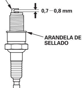
Cuando instale una bujía nueva, apriétela 1/2 de vuelta después de haberse asentado la bujía para comprimir la arandela.
