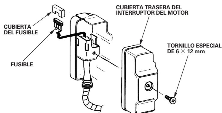
Las fallas frecuentes del fusible normalmente indican que hay un cortocircuito o una sobrecarga en el sistema eléctrico. Si el fusible se quema repetidamente, lleve el motor a un concesionario de servicio Honda para que lo repare.
