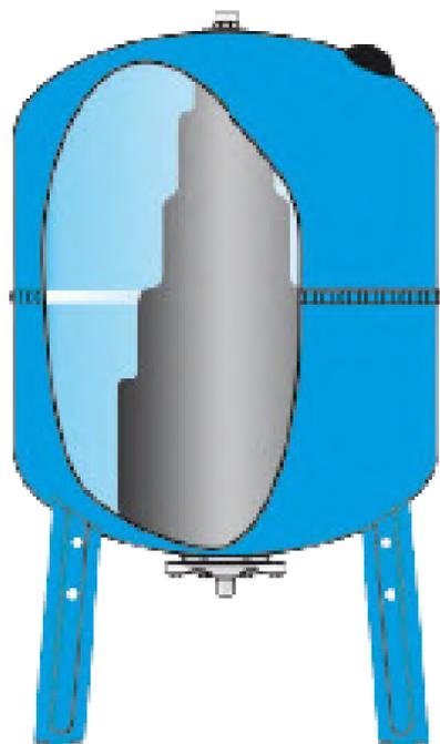
Lorsque l'installation est en fonctionnement, la pompe **génère une pression** qui remplit d'eau la vessie à l'intérieur du réservoir.
