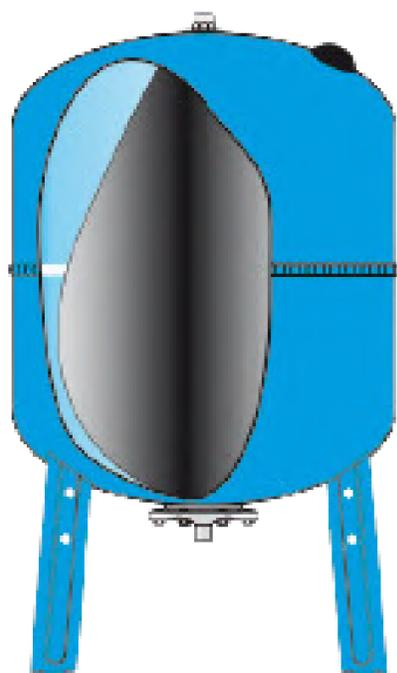
Lorsque la pression du système atteint son niveau maximal prédéterminé, **la pompe s'arrête**. À ce moment-là, le réservoir contient la quantité maximale d'eau. La vessie se dilate pour occuper presque tout le volume interne du réservoir. Si le système en a besoin, l'eau est **libérée sans solliciter la pompe**, en utilisant uniquement la pression présente dans le coussin d'air.
